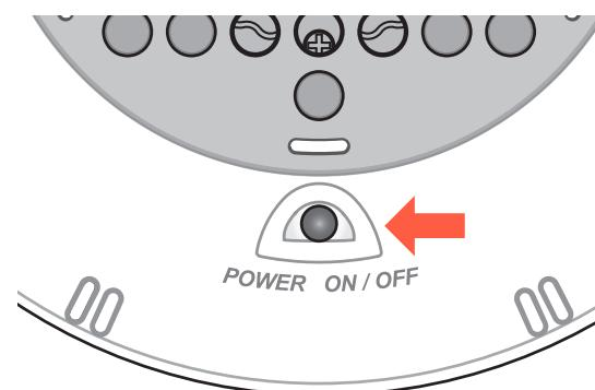
スイッチを長押し（約2秒間）してください。イルミネーションランプが全消灯し、水素生成を停止します。
